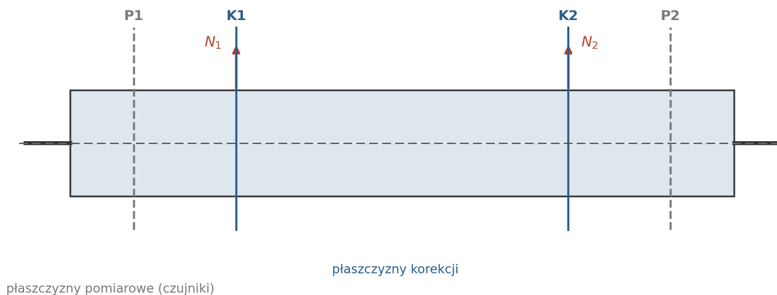
Rys. 3. Płaszczyzny korekcji K_1 , K_2 i płaszczyzny pomiarowe P_1 , P_2 na wirniku.
